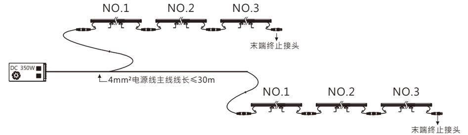
注:单色常亮,灯具每个电源单回路可串联3支灯具,且电源连接灯具总数量不要超过电源功率的80%。
